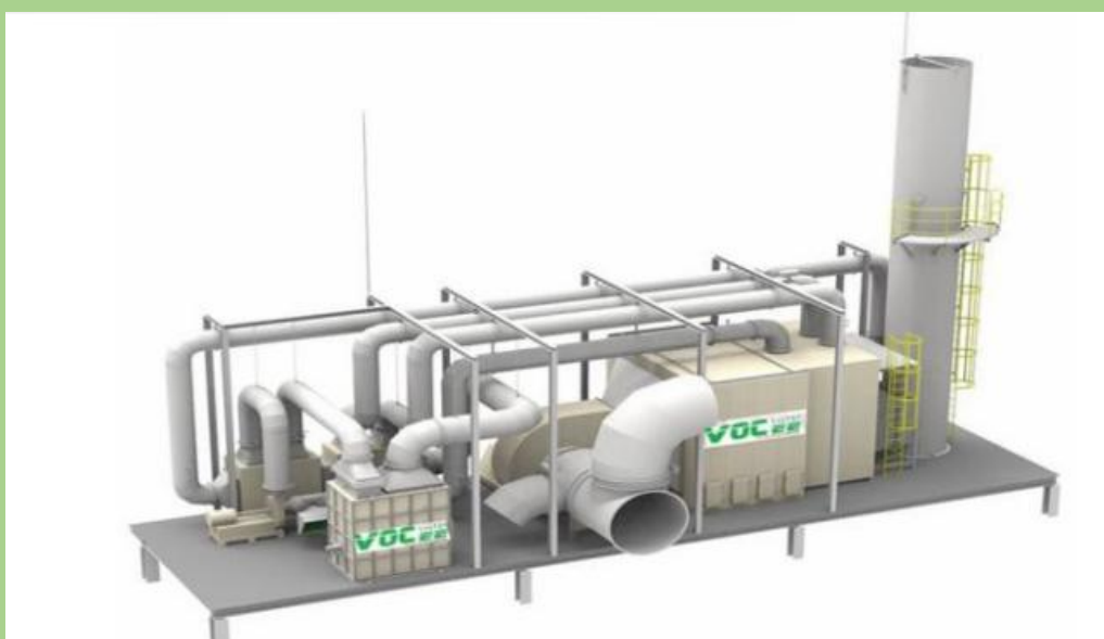
图 6.2.2 沸石转轮设备示意图
