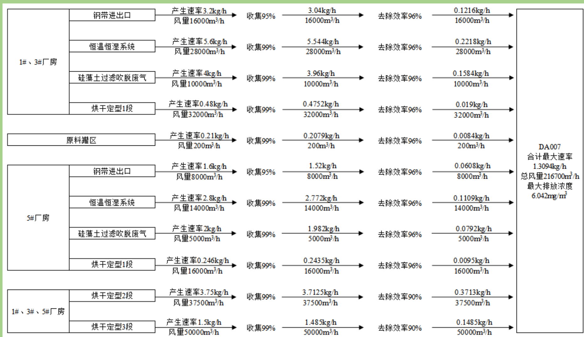
图 3.6.1-2 DA007 最大排放情况计算过程图示
