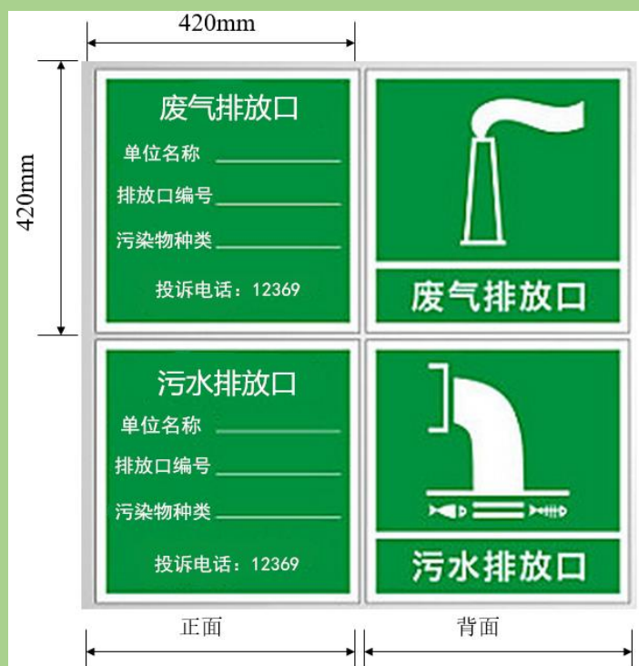
图 8.1.2-1 规范化废气、废水排放口标识牌（一）
